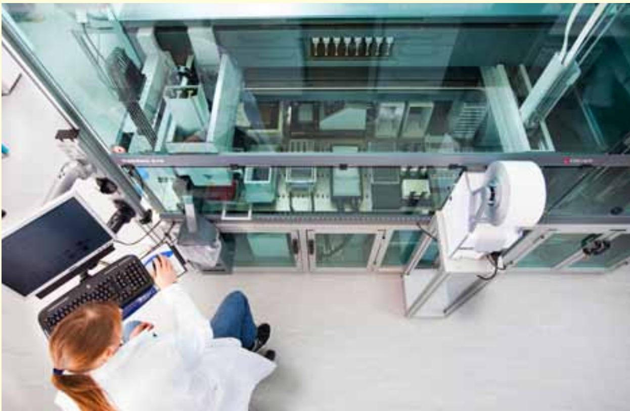
Laborautomationsanlage am Zentrum für Biosystemanalyse (Albert-Ludwigs-Universität Freiburg). Diese Robotikplattform wird für molekularbiologische Screens und kombinatorische Experimente im Hochdurchsatz eingesetzt.
